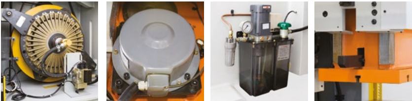
Freio e fricção de ação eletropneumática com sistema de válvula solenoide duplo Regulagem motorizada da altura do martelo Sistema de lubrificação a óleo com bomba motorizada e distribuidor de vazão progressiva Quatro guias do martelo com oito faces retificadas deslizantes sobre longas réguas de bronze
