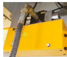
Bomba de proteção de sobrecarga com reservatório
